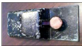
Sl. 40. Nemački ručni taster iz II Svetskog rata marke "D.R.P. Junker" (ja sam mu na ručki stavio vosak zbog lakšeg kucanja na QRQ takmičenjima)
