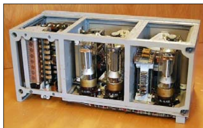
Sl. 36c. Pogled na zadnji deo šasije od predajnika Lorenz LO40K39d
