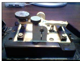
Sl. 40a. Pogled iznutra na ručni taster "D.R.P. Junker"
