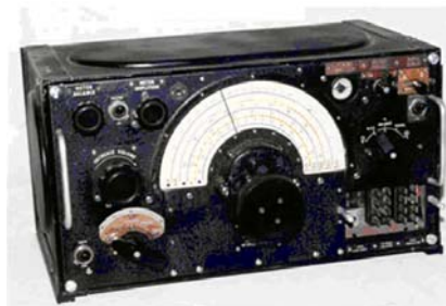
Sl. 36f. Engleski vazduhoplovni prijemnik iz II Svetskog rata R-1155
