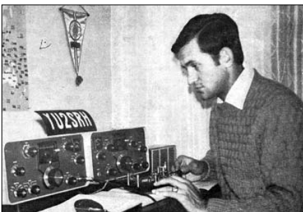
Sl. 39c. Savremeni SSB uređaji za KT u SRH; operator na stanici YU2SRH (RX SB300 i TX400, a antena je bila W3DZZ, koju je proizvodio SRH)
