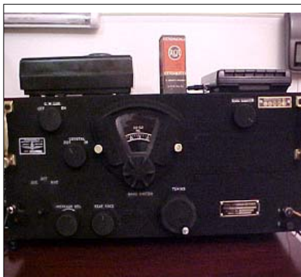
Sl. 38. Današnji izgled prijemnika BC-348Q, proizvedenog 1943. koga je američki amater KC8VWM reparirao
