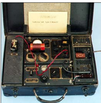
Sl. 33a. Prenosni primopredajnik 3 Mk II iz II Svetskog rata
