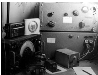
Sl. 36a. Amaterska KT stanica od Bude YU1NSD; TX: "Tesla" tj. reparirani nemački predajnik "Lorenz" iz II Svetskog rata; RX: engleski R-1155 (1965)
