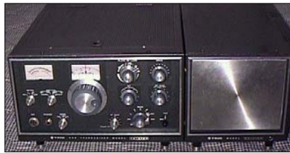
Sl. 34b. Amaterski transiver "Trio" TS-510 sa ispravljačem i zvučnikom
